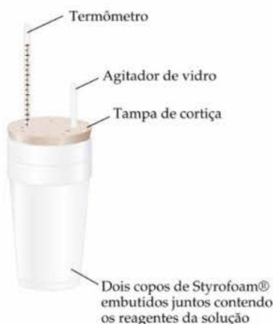
**Figura 5.18** Calorímetro de copo de café, no qual as reações ocorrem a pressão constante.
