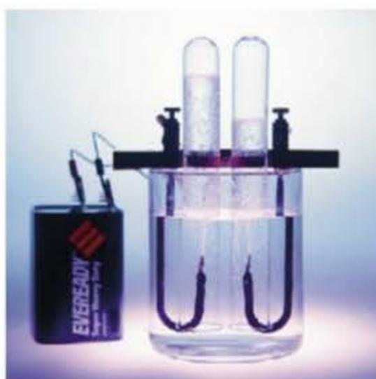
**Figura 1.7** A água decompõe-se em seus elementos constituintes, hidrogênio e oxigênio, quando uma corrente elétrica direta passa por ela. O volume de hidrogênio (à direita) é duas vezes maior que o volume do oxigênio (à esquerda).
