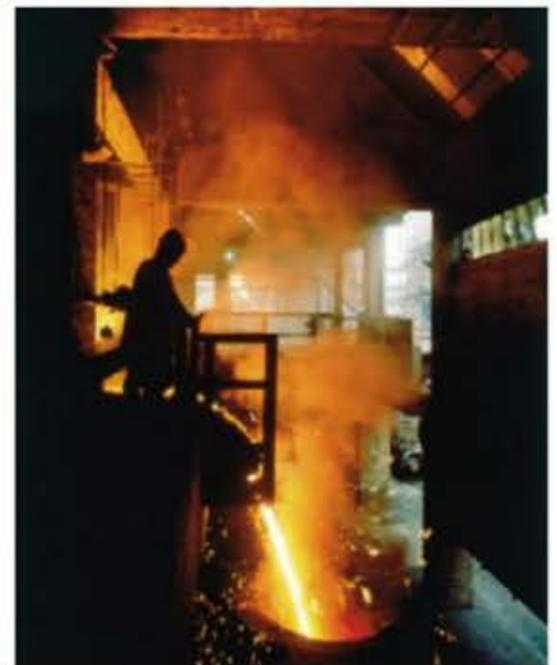
**Figura 6.5** A cor e a intensidade de luz emitidas por um objeto quente depende da temperatura do objeto. A temperatura é mais alta no centro desse derramamento de aço fundido. Como resultado, a luz emitida do centro é mais intensa e de comprimento de onda mais curto.
