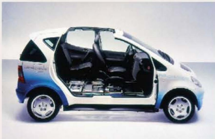
**Figura 1.19** Seção reta de um carro alimentado por células a pilha.
