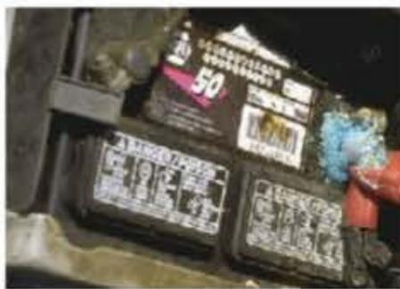
**Figura 4.11** A corrosão nos terminais de uma bateria, causada pelo ataque ao metal, provocada pelo ácido sulfúrico.
