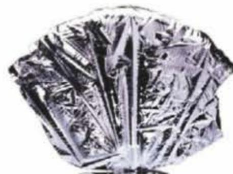
**Figura 7.18** Silício elementar, que é um metalóide. Apesar de ter aparência de metal, o silício é quebradiço e não é bom condutor térmico ou elétrico comparado aos metais. Grandes cristais de silício são separados em finos *wafers*, isto é, em finas placas de silício, para uso em circuitos integrados.
