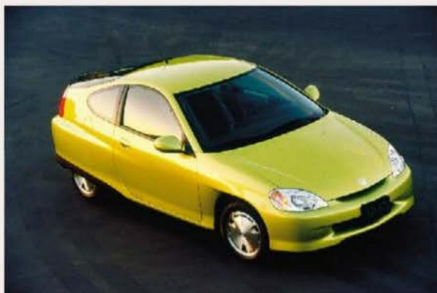
**Figura 5.25** O Honda Insight, carro híbrido no qual tanto os motores a baterias quanto a gasolina provêm energia para movê-lo, bem como para impelir dispositivos auxiliares.
